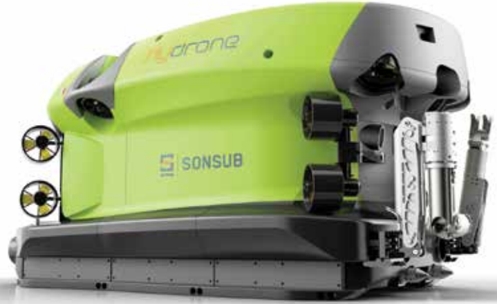
● الطائرة "هايدرون-آر" يمكنها تدعيم أعمال بناء وصيانة المنصات البحرية
