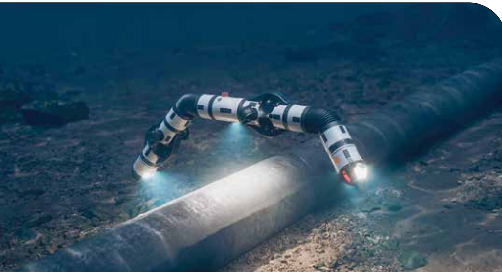
● الروبوت "إيلوم" خلال تنفيذ مهام صيانة لأنبوب نفط بحري
